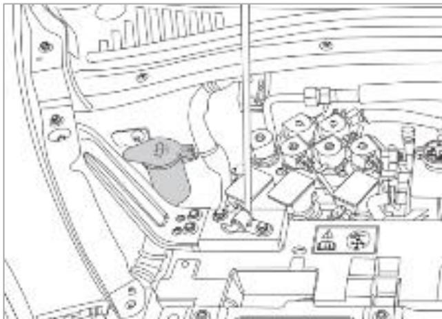
Бачок для жидкости омывателя лобового стекла находится в моторном отсеке слева.
