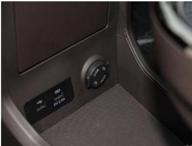
USB-порт поддерживает передачу данных с MP5. Интерфейс источника питания USB предназначен только для зарядки внешних устройств.
