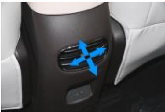
Угол наклона можно регулировать, перемещая регулировочный переключатель в центре воздуховода вверх или вниз, направление воздушного потока – перемещая влево или вправо.
