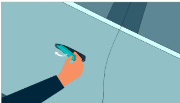
Когда автомобиль разблокирован, наружная дверная ручка автоматически выдвигается. Дверь можно открыть, потянув за наружную ручку.
