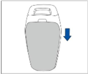
2. Снимите водонепроницаемую резиновую заглушку батарейки.
