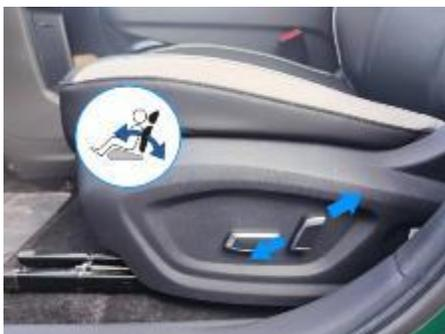
Нажимайте переключатель в указанном стрелками направлении, и угол наклона спинки сиденья изменится соответствующим образом.
