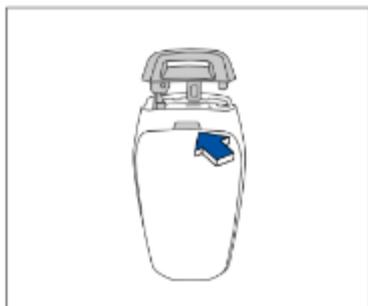
1. Нажмите кнопку фиксатора и извлеките механический ключ.
