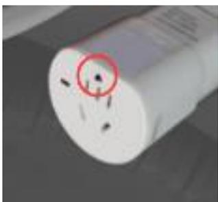
3. После подсоединения разъема инвертора подключите электрооборудование и нажмите микропереключатель на разъеме инвертора (как показано на рисунке). Индикатор зарядки автомобиля станет желтым, затем загорится зеленым, и начнется разряд через инвертор.
